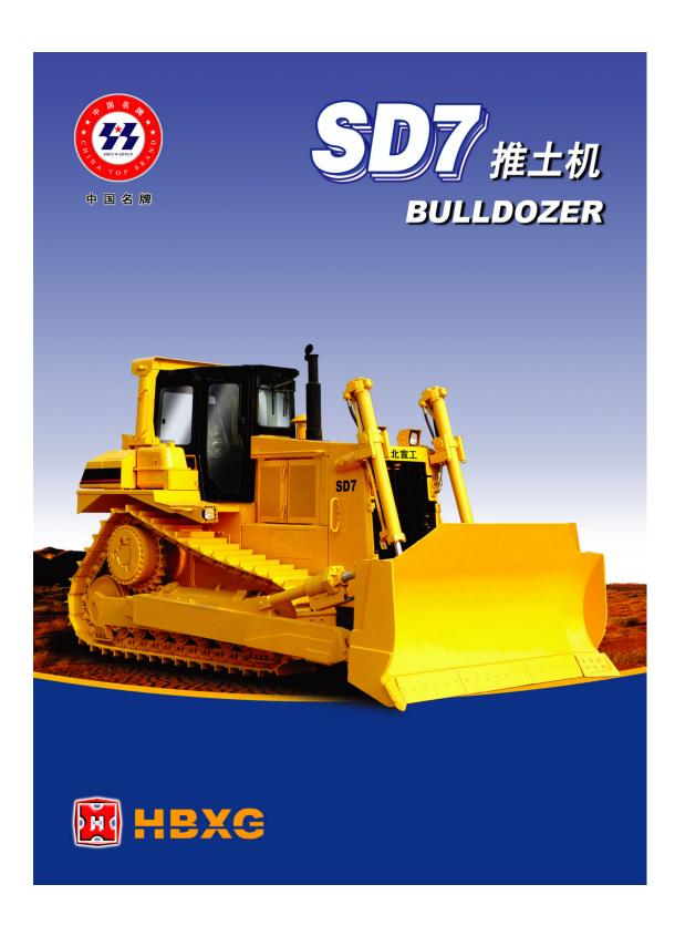
半刚性悬挂、液力机械传动、高驱动,全液压操纵的履带推土机;整机模块化设计,拆装维修简便;差压溢流、液压系统环保节能、工作效率高。按人机工程设计的操纵系统轻便、省力、准确。电子监控、防倾翻司机室;可选配U型铲、单钩、三钩松土器等多种工作装置;是交通、沙漠、油田、电力、矿山等大型土石方施工的最理想机械。
