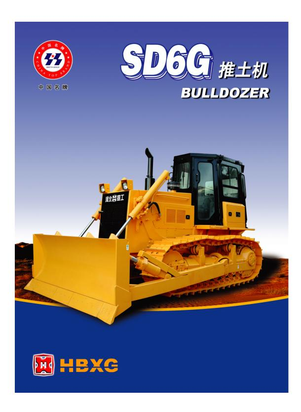
采用上柴卡特技术的C6121发动机,扭矩储备系数大,液力机械变矩器高效区宽、效率高。转向、制动联动,制动液压助力;终 传动齿轮大变位设计,承载能力高、使用寿命长,同时终传动采用轴承游隙免调整结构,维修方便;平衡梁采用免润滑结构,降低维 护成本;整机布局合理、驾驶舒适、视野开阔、维修方便、工作可靠。同时有三钩松土器,U型铲(铲刀容量7.4m³)等供用户选购。
