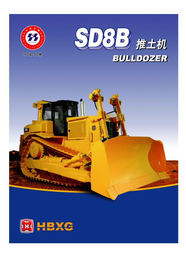
SD8B推土机是驱动轮高置、液力机械传动、弹性悬挂、液压操纵的履带推土机。功率外分流式液力机械变矩器,行星动力换档、单杆操纵变速箱。差压溢流、集成化的工作装置液压系统。整机模块化设计是最突出的结构特点,操纵系统轻便、省力、准确,并采用了电子监控系统。可选配多种工作装置和附属装置,是多种大型土石方施工的理想机械。
