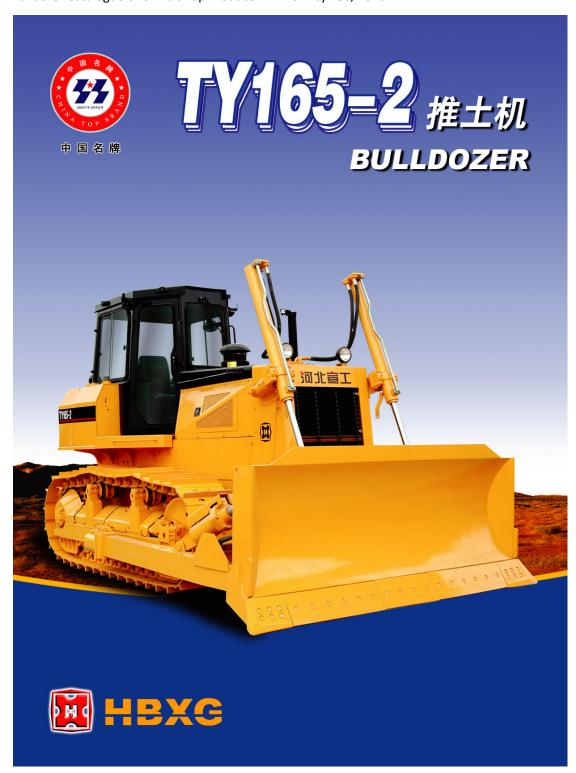
半刚性悬挂、液力传动、液压助力操纵的履带推土机。先导工作装置操纵,单杆转向与制动操纵。生产效率高、通过能力强、操 纵轻便、结构简单、维修方便。可选配三钩松土器、U型铲刀(铲刀容量7.4m³)等多种装置。是交通、油田、 电力、矿山等土石方施 工的理想机械,是TY165升级产品。
